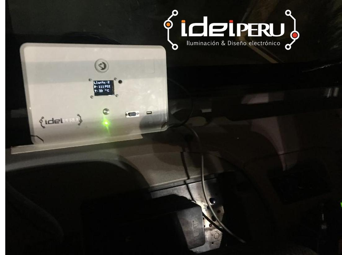
El monitor se instala dentro de la cabina del operador y los sensores transmisores se fijan dentro de los neumáticos mediante parches especiales. Estos transmisores miden la presión y temperatura interna de los neumáticos, y envían la información al módulo receptor para que pueda ser observado por el operador. El monitor es capaz de emitir alarmas configurables para alertar al operario de cualquier condición anormal de los neumáticos.
